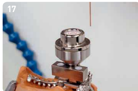
17 Для эрозии фиксаторной оси под углом в 90° к припасовке фиксатора, фиксаторная часть (№ заказа 30-1242) вставляется в фиксаторную припасовку и на ней монтируется осевая направляющая (№ заказа 30-1602). Вставленный в приёмку фиксатора уровень (№ заказа 82-1201) служит для регулировки параллельности.
