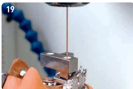
18 Для точной принудительной подачи электрод был введён в тефлоновую втулку направляющей электрода. Втулка подходит к электроду 0,8 мм.
