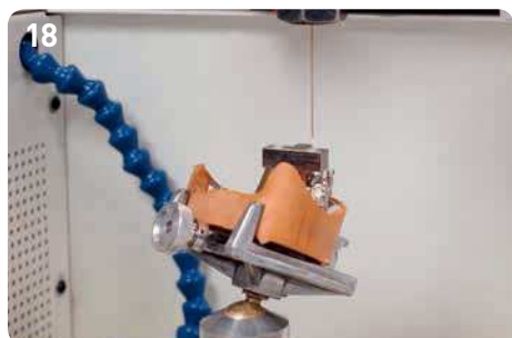
18 Для точной принудительной подачи электрод был введён в тефлоновую втулку направляющей электрода. Втулка подходит к электроду 0,8 мм.
