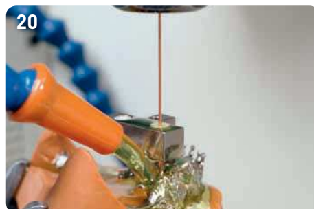
20 После того как запущена подача диэлектрика, начинается процесс искровой эрозии - смотри в списке параметров.
